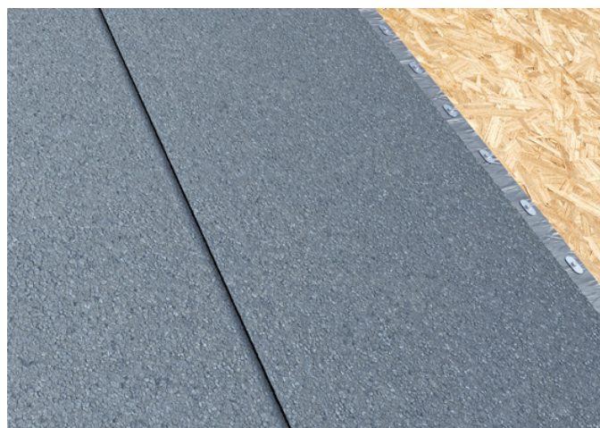
Ilustr. 333 Mocujemy wkrętami prawą stronę zakładu podłużnego drugiego arkusza papy.
