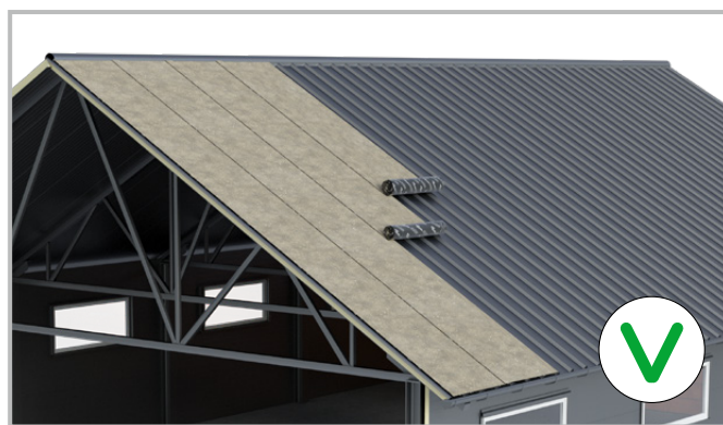
Rys. 4 Kąt nachylenia połaci powyżej 20%
